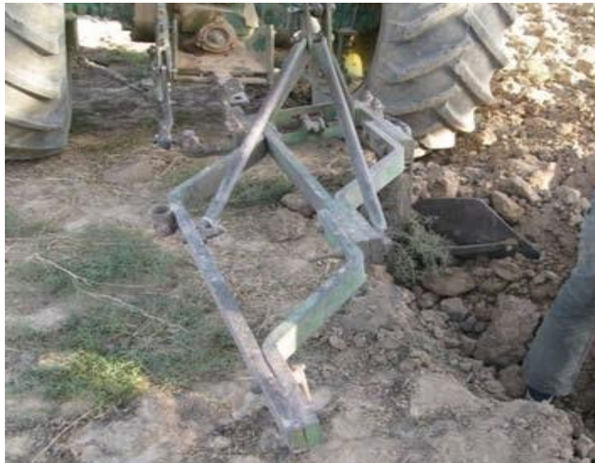
گاوآهن برگردان دار تک خیش برای برداشت و کندن پیازهای زعفران
