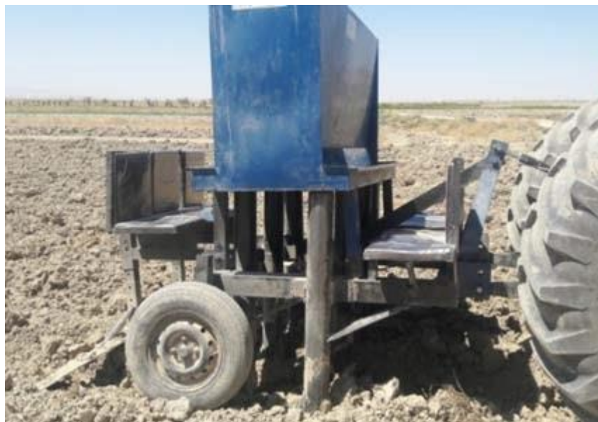
شکل ۶ پیازکار شش ردیفی نیمه خودکار
