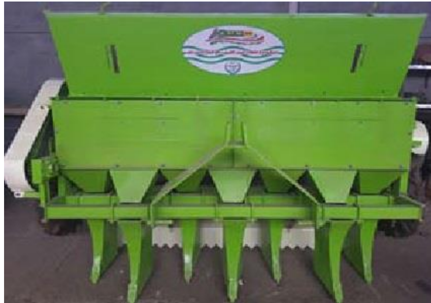
شکل ۷ پیازکار هفت ردیفی تمام خودکار زعفران
