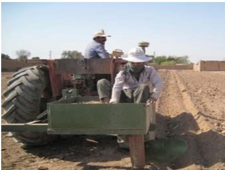
۵- خیش یک طرفه شده به همراه مخزن پیاز
